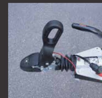
Sicherheitskupplung mit Spurstabilisierung
