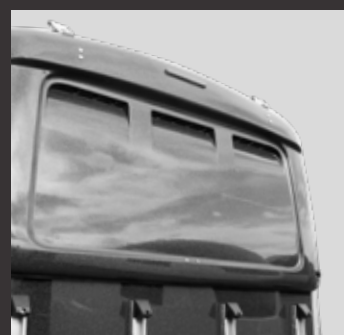
GFK-Windflap mit integrierter dritter Bremsleuchte (optional) für Xanthos®, Zephir® und Maximus®
